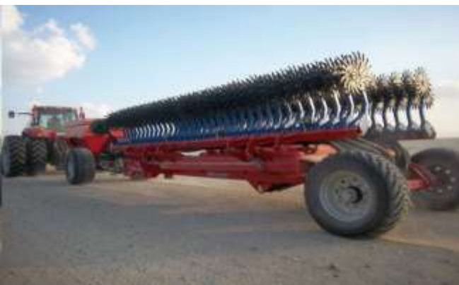
Роторный культиватор шириной захвата 16 м
